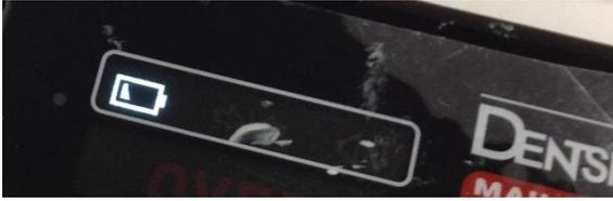
**EL LED INDICADOR DE CARGA DE LA PILA, AÚN Y ESTANDO CARGADO AL 100% MARCA ÚNICAMENTE UNA RAYA**
