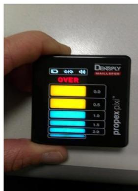
A partir de ese momento, el localizador irá encendiendo paulatinamente todas las luces, hasta completar un ciclo completo. Acabado el ciclo completo volverá de nuevo a encenderse la primera barra azul y volverá a hacer el ciclo, así sucesivamente hasta que la batería se descargue por completo. La descarga total de la batería podría prolongarse durante más de 24hr.
