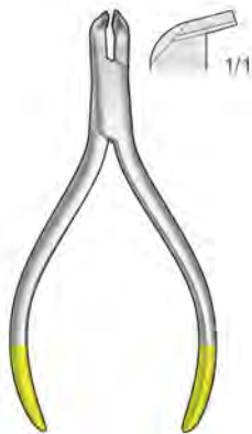
Alicate corte distal TC LX-DS1 - Hasta 0,5 mm redondo, 0.41 x 0.56 mm rectangular y 0,4 mm twist.
