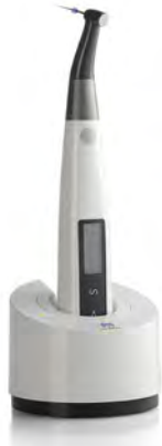
Tri Auto ZX2 6961 - Motor inalámbrico con localizador de ápices integrado, con un peso de tan solo 140 g.
